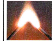
Ein Lichtbogen führte zum Totalausfall der elektrischen Anlage!
